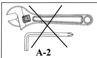
Ziehen Sie in diesem Schritt die Muttern und Schrauben nicht fest an. Wenn das "Jetzt festziehen"-Bild (siehe oben) im nächsten Schritt erscheint, stellen Sie sicher, dass alle Schrauben die bereits montiert sind auch festgezogen wurden.
